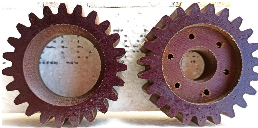
Фиг. 3.10. Задвижвано зъбно колело от механизма за завъртане на куполата на БМП-1П
