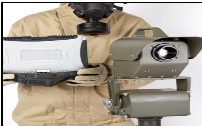
Фиг. 3.40. Second Sight MS детектор на газови облаци
