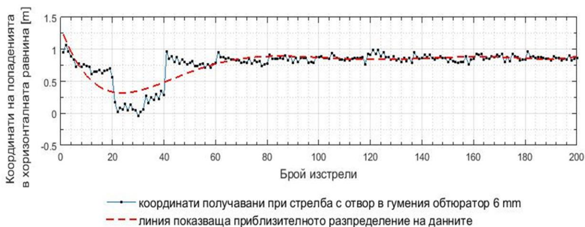
Фиг. 3.14 Изменение на стойностите на координатите на попаденията в хоризонталната равнина, в зависимост от изменението на броя изстрели при стрелба с предварително изработен цилиндричен отвор в гумения obtюратор с диаметър 6 mm.
