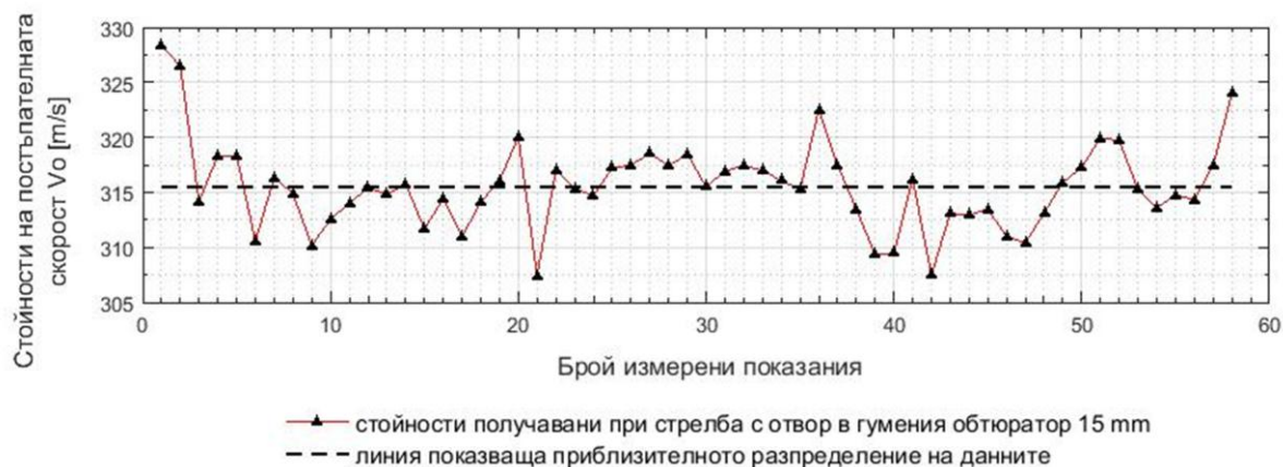
Фиг. 3.3 Изменение на стойностите на постъпателна скорост на куршума при стрелба с предварително изработен цилиндричен отвор в гумения обтюратор с диаметър 15 mm.
